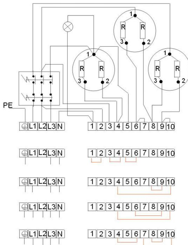
**3 kW** 1 PE - N AC 230 V / 50 Hz
