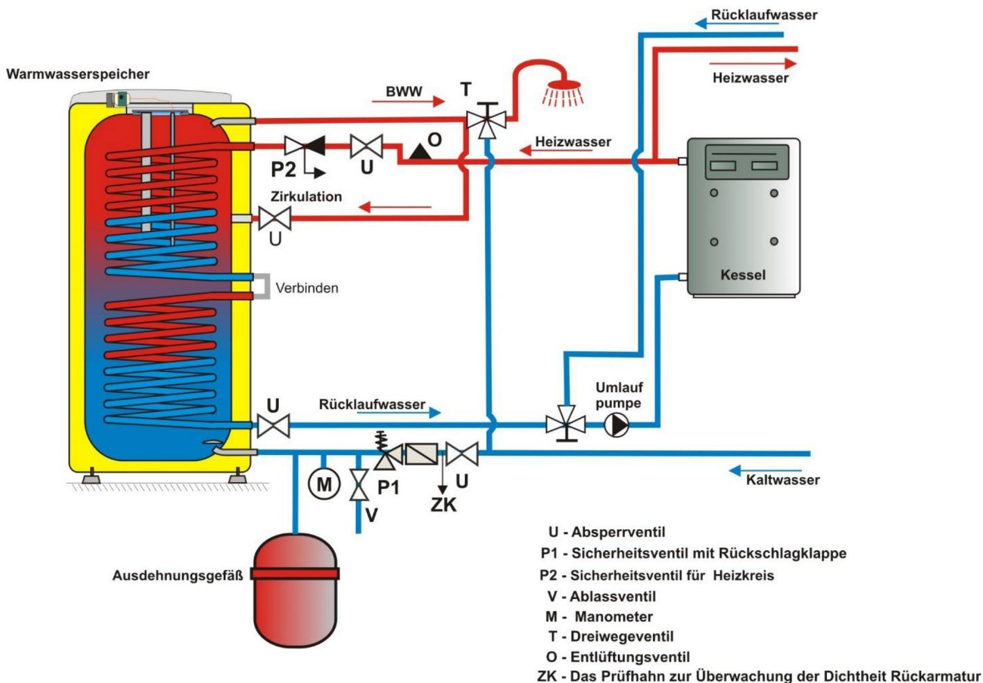
\* Das Ausdehnungsgefäß zu verwenden ist keine Bedingung für korrekten Anschluss, aber nur dann möglich, alternative Lösung
