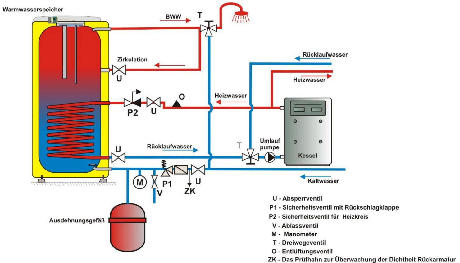
\* Das Ausdehnungsgefäß zu verwenden ist keine Bedingung für korrekten Anschluss, aber nur dann möglich, alternative Lösung
